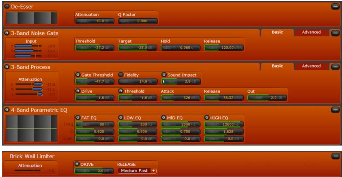
Estos controles permiten ajustar los parámetros para cada sección de procesamiento. Todos los parámetros se guardarán con el pre ajuste. Cualquier cambio realizado en los canales que contengan el mismo pre ajuste los afectará simultáneamente.
