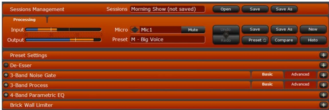
Este segmento de la ventana es donde ocurre la mayor parte de la configuración de procesamiento. Para establecer ajustes en la sección “Preset Settings” y controlar el procesamiento en la sección “Processing” cada sección puede ser expandida realizando clic sobre el signo **+** ubicado en el costado derecho. Si la sección se encuentra ya expandida el signo reflejado será **-**, realice clic para contraer las opciones.
