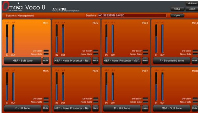
Despliega los nombres de los canales con todos los medidores y controles disponibles, incluyendo los niveles de entrada y salida, LEDs De-Esser y Noise Gate, Preset Selection y Mute.
