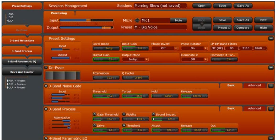
Dentro del menú “Preset settings”, las secciones “De-Esser”, “3-Band Noise Gate” y “3-Band process” se encuentran visibles. La sección “4-Band Parametric EQ” esta desactivada, al igual que “Brick Wall Limiter”.
