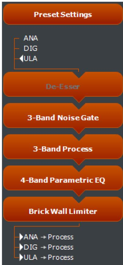
Este panel permite observar un resumen de toda la estructura de procesamiento para el canal seleccionado y sus preajustes. (Realicemos un repaso rápido – Es posible seleccionar un canal haciendo clic sobre su descripción en la parte superior de la ventana. Todos los canales con el mismo preajuste cargado serán seleccionados simultáneamente.)
