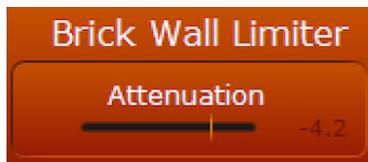
Despliega la cantidad de reducción de ganancia aplicando por el “Brick Wall Limiter”.
