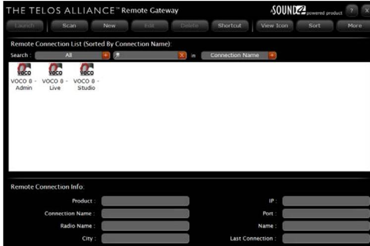
Una vez instalado el "Remote Gateway", se necesitara añadir el VOCO 8 a la lista de conexiones en el software Las unidades en red se buscan haciendo clic en "Scan".
