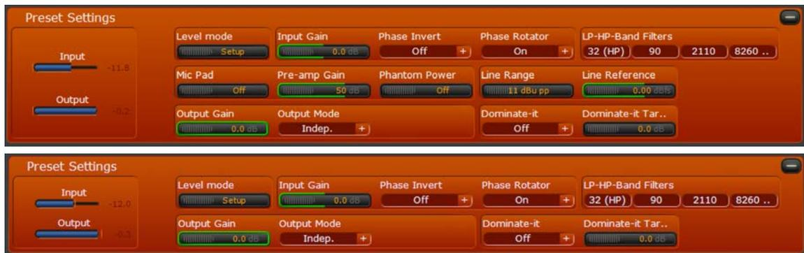
Dependiendo de cómo se haya ajustado la opción “Preset Override”, ciertos parámetros pueden estar disponibles en la sección de configuración “Preset Settings”, incluyendo el rango de línea, nivel de referencia, ganancia de pre amplificación, pad y alimentación Phantom. Estas funciones serán cubiertas en detalle en el Capítulo 12.
