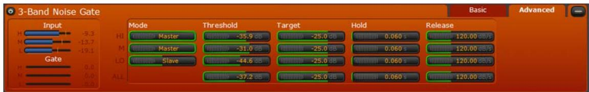
Los controles avanzados de la sección “3-Band Noise Gate” son virtualmente idénticos a los controles básicos pero añaden las funciones de mediciones adicionales, acceso a ajustes de acoplamiento de la banda y a los controles de cada banda de manera individual.
