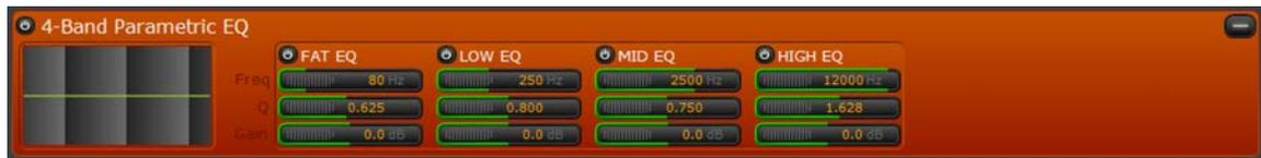
La opción de ecualización paramétrica de 4 bandas “4-Band Parametric EQ” permite un último ajuste de sonido fino posterior a la sección de procesamiento de 3 bandas para alcanzar la textura de sonido deseada.
