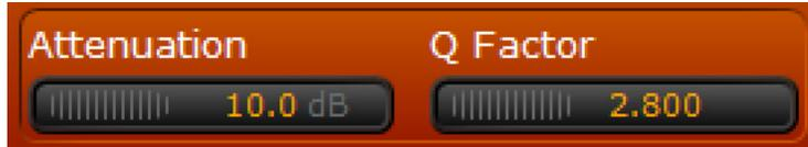
Ajusta automáticamente la cantidad máxima de atenuación aplicada a los sibilantes detectados.
