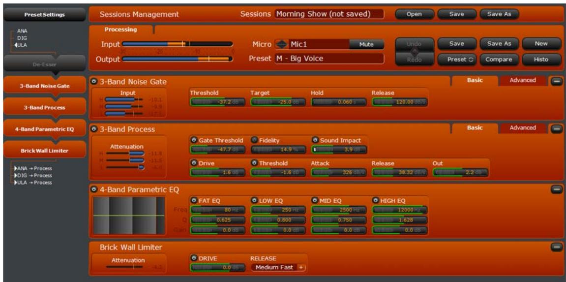
Si realiza clic sobre la sección “3-Band Noise Gate”, las secciones “3-Band Noise Gate”, “3-Band Process”, “4-Band Parametric EQ”, y “Brick Wall Limiter” se harán visibles, mientras se ocultaran las secciones “Preset Settings” y “De-Esser”. Los controles de la sección “Sessions Management” y “Processing” para preajustes serán siempre visibles.
