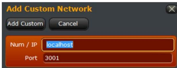
Si por alguna razón no aparece la interfaz, haga clic en "Add Custom" para agregar una dirección IP personalizada. Esta función también puede utilizarse para agregar unidades VOCO 8 situadas remotamente que puedan no ser detectadas mediante el escaneo de una red local. El puerto predeterminado para compartir el pre ajuste es 3001 y no se debe cambiar a menos de que sea necesario.
