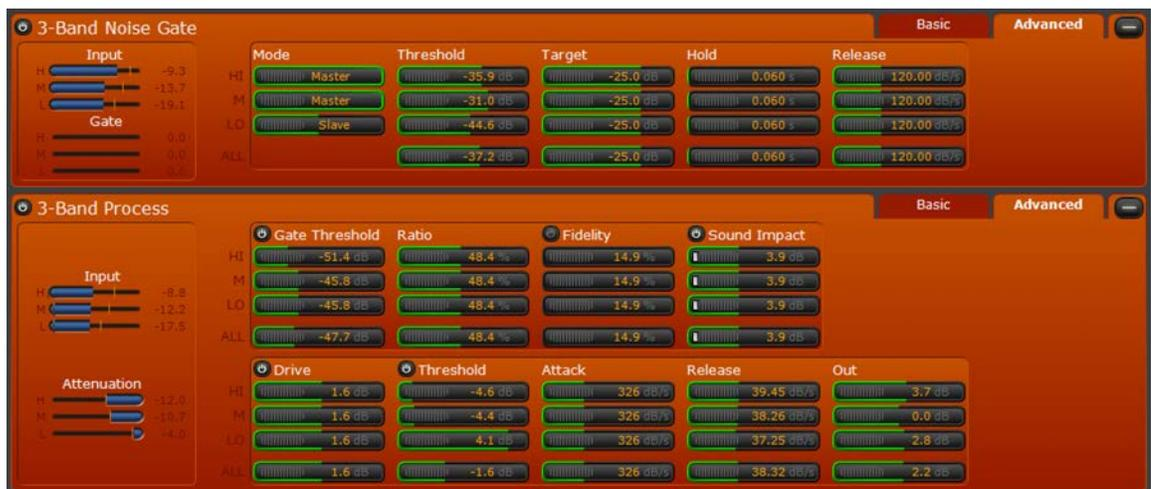
Las secciones “3-Band Noise Gate” y “3-Band Processing” contienen también opciones avanzadas, que les permiten un ajuste fino a las 3 bandas de procesamiento individual. Los parámetros de procesamiento serán cubiertos a detalle en el Capítulo 13.
