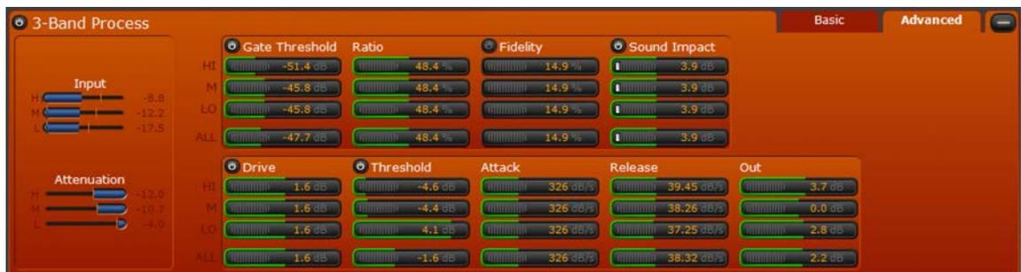
Los controles avanzados de la opción “3-Band processing” son virtualmente idénticos a los controles básicos pero añade funciones adicionales de medición, acceso a ajustes del compresor de ratio y acceso al control de cada banda de manera individual.
