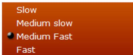
Ajusta el tiempo de recuperación de la sección limitadora final. El valor predeterminado se identifica como “Medium Fast”.
