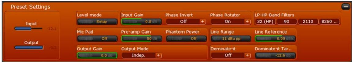
Con la función “Preset Level Override” habilitada en la configuración de entrada, varias opciones adicionales aparecerán en la barra de configuración de pre ajustes “Preset Settings”.
